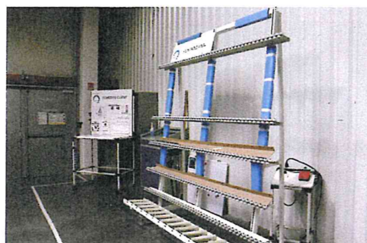
Zone de contrôle final : 25 menuiseries sont prélevées chaque semaine pour vérifier la qualité des produits. La dématérialisation a permis d'augmenter les contrôles qualité et donc de beaucoup réduire les retours au SAV.
