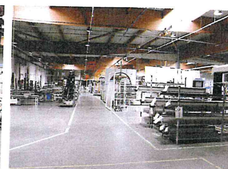
Des aménagements de management visuel sont en cours comme la peinture des allées, pour matérialiser les zones de circulation et de travail.
