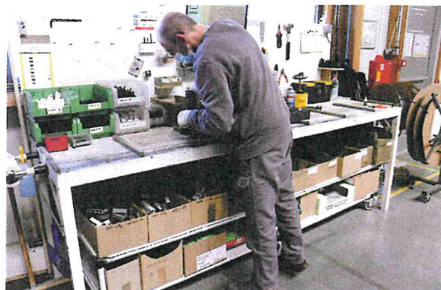
Équipement des accessoires (joints, roulettes, crémones et bouchons) sur un poste qui n'a pas encore bénéficié des améliorations d'un chantier de progrès.
