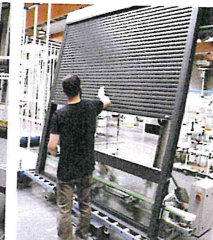
Chaque volet roulant est testé en usine, avec photo témoin, puis vérifié avant emballage.
