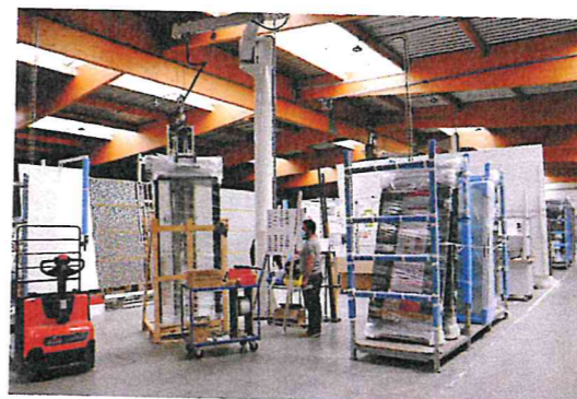
Les produits sont poussés à la main de poste en poste. La réduction progressive du port de charges a permis de diviser par trois les accidents de travail par rapport à 2012. Ce poste est équipé d'un manipulateur.
