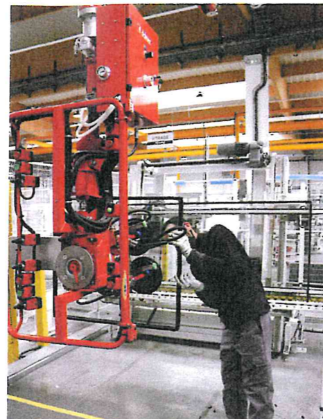
Sur cette ligne automatisée, l'opérateur positionne les joints prédécoupés automatiquement autour du vitrage.
